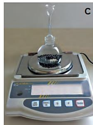
Massa do picnómetro com a amostra do metal e com água até ao traço de referência ( m_C )
